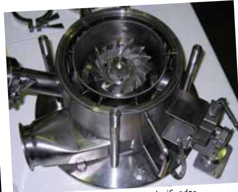
Vista interior del molino clasificador por aire de tamaño de laboratorio
