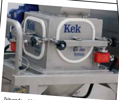
Trituradora M303 con puertas de acceso abatibles
